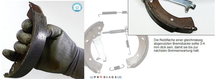
Die Reibfläche einer gleichmässig abgenutzten Bremsbacke sollte 3-4 mm dick sein, damit sie bis zur nächsten Bremsenwartung hält.
